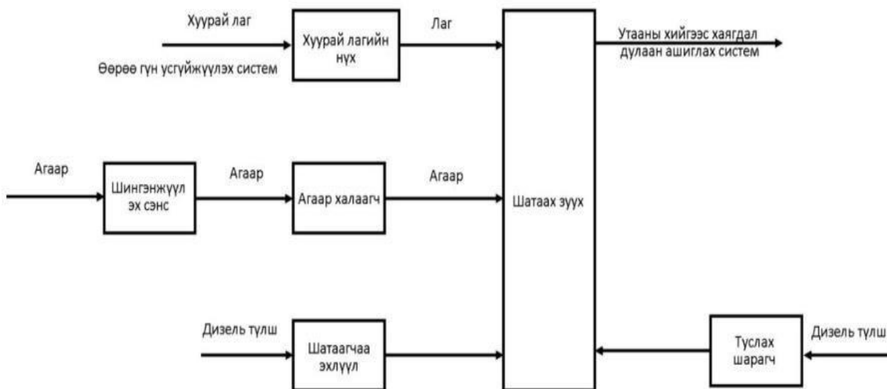
Abbildung 13. Schematischer Gesamtprozess der Klärschlammverbrennung
